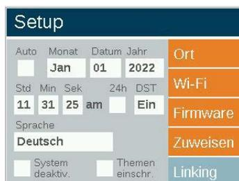
4. Scrollen Sie zum Feld **Gerätenummer** und wählen Sie die gewünschte Nummer (1-10) aus. Jedem Gerät in einer Anlage muss eine eigene Nummer zugewiesen werden. Hinweis: Die Nummer 0 wird dem Wireless Linking Modul zugewiesen, das am Luxor Hauptsteuergerät mit Bedienfront verwendet wird.
