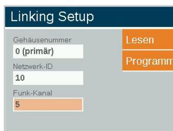
7. Scrollen Sie weiter zu **Programm** und klicken Sie den Drehschalter. Unten im Display wird „Zuweisung erfolgreich“ angezeigt. Wenn die Zuweisung fehlschlägt, wiederholen Sie den Vorgang.
