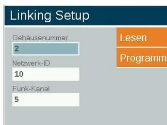
5. Scrollen Sie zum Feld **Netzwerk-ID** und wählen Sie die gewünschte ID (0-255) aus. Die Netzwerk-ID muss für alle in einer Anlage installierten Wireless Linking Module gleich konfiguriert werden.
