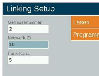
6. Scrollen Sie zum Feld **Funk-Kanal** und wählen Sie den gewünschten Funk-Kanal (1-10) aus. Der Kanal muss für alle in einer Anlage installierten Wireless Linking Module gleich konfiguriert werden.
