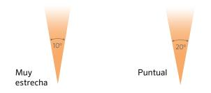
Las luminarias de la serie FX Luminaire Designer cuentan con LED integrado con muchas opciones de ángulo del apertura para dar máxima flexibilidad al diseño de la iluminación.
